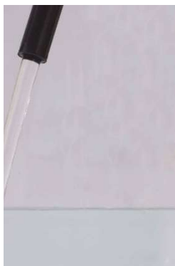
Fig. 5 : Le tuyau de remplissage doit être placé au-dessus de la surface de l'eau. En cas de fin de tuyau immergé de l'eau pourrait couler du bac de filtration vers le réservoir ou inversement selon le principe des vases communicants, jusqu'à égalité des niveaux. En outre, pour la même raison, le réservoir ne doit pas être plus haut que la sortie du tuyau de remplissage, car l'eau pourrait couler de manière non contrôlée.
