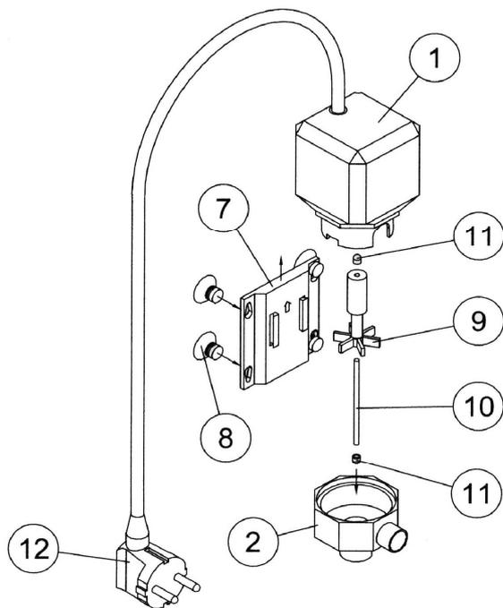
**Abb. 6: Aufbau des Powerfilters PF 1000:**
