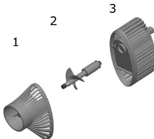
**Abb. 5: Aufbau NanoProp 5000**
