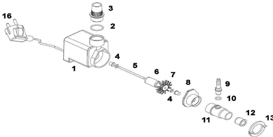
Schéma 4: Dispergatorpumpe AQ 1200
